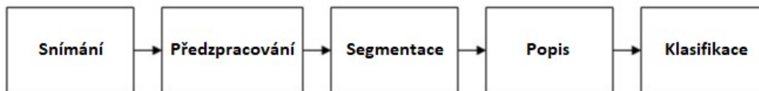
Obr. 1: Zjednodušený řetězec zpracování obrazu
